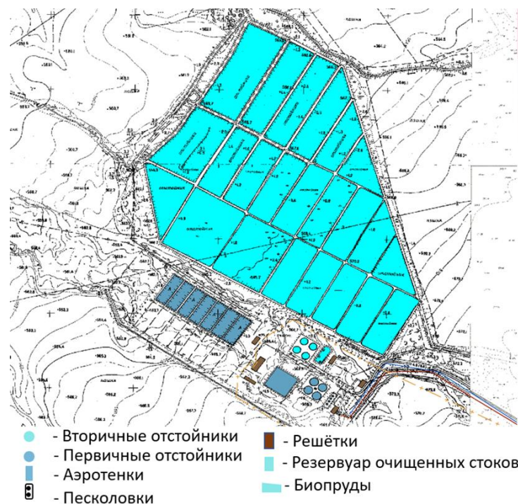
Рисунок 1 – Схема очистных сооружений ГТКП "Жетысу Водоканал» [2]
